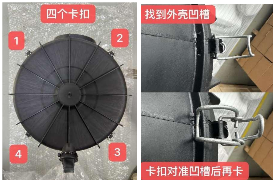
图三.二级空滤滤芯安装（按照 1324 顺序紧固卡扣、排水口向下）示意图
