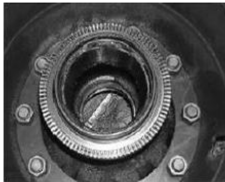
图 2 齿圈装在轮毂上
