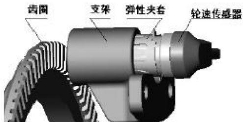
图 5 前桥传感器与齿圈安装配合
