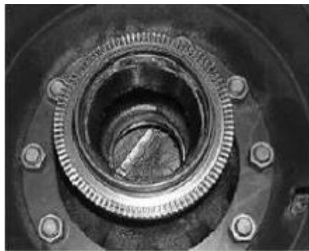
图 2 齿圈装在轮毂上
