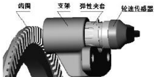
图 5 前桥传感器与齿圈安装配合
