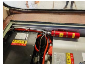
图 安装在发动机舱内的自引爆干粉灭火器
