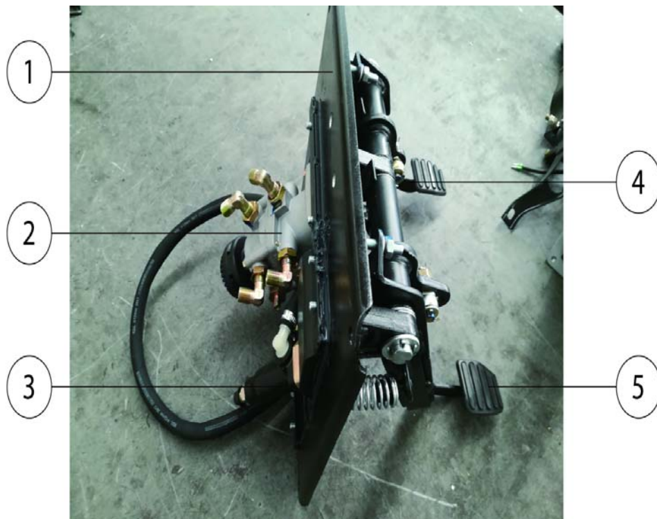
1. 组合踏板支架 2. 制动总泵 3. 离合总泵 4. 制动踏板 5. 离合踏板
