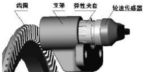
图 5 前桥传感器与齿圈安装配合
